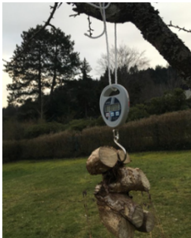
Figure II - 40 : Exemple d'une balance suspendue électronique pour accrocher des poids jusqu'à 10 kg
