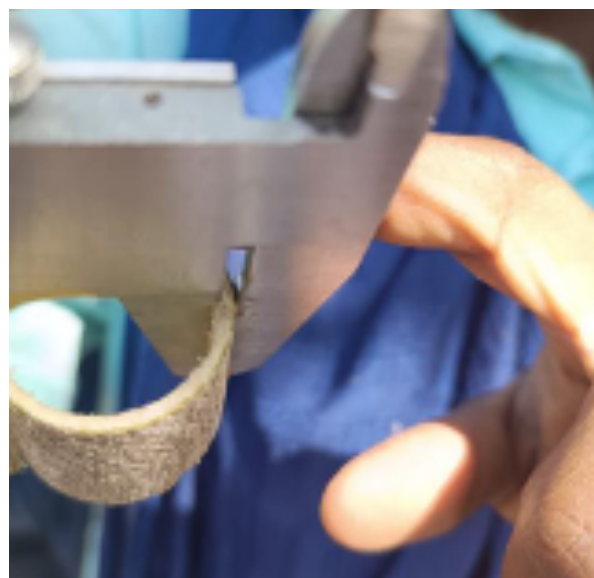
Figure II - 31 : Mesure de l'épaisseur de l'écorce d'une section de tronc à l'aide d'un pied à coulisse
