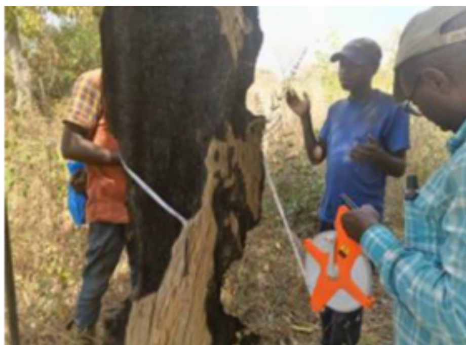
Figure II - 11 : Mesure du DHP d'un tronc mort avec un ruban-mètre
