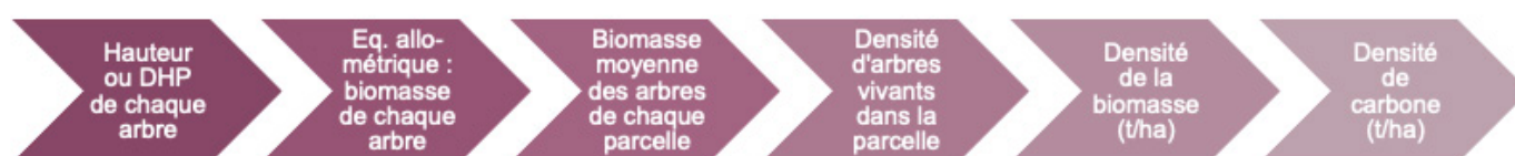
Figure IV - 25 : Flux de calcul pour estimer la densité de la biomasse et de carbone d'acacia à partir de drones
