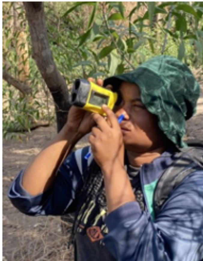
Figure II - 4 : Utilisation d'un dendromètre à rayon de laser pour mesurer la hauteur des acacias
