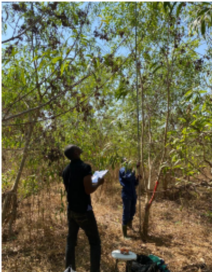
Figure II - 3 : Mesure de la hauteur de l'arbre avec une barre fabriquée avec des tubes métalliques ou de PVC
