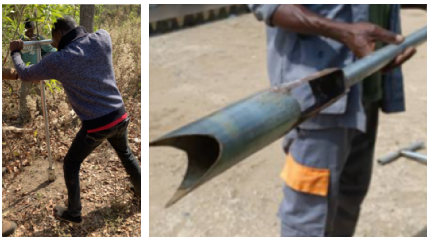
Figure II - 15 : A gauche : Enfoncement d'un carottier pour le prélèvement d'un échantillonnage du sol. A droite : Vue en détail d'un carottier de fabrication locale
