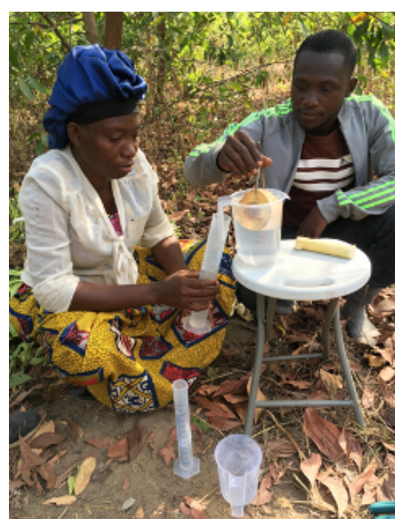
Figure II - 34 : Mesure du volume d'un échantillon de bois par la méthode de déplacement d'eau
